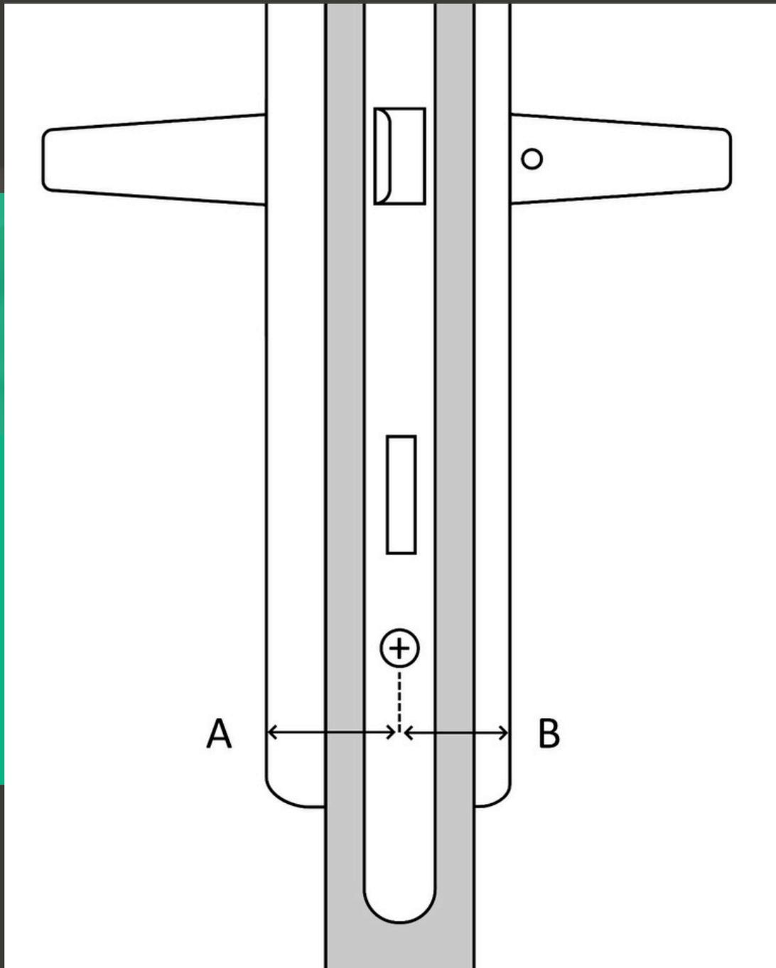
**Tipp:** Das Zylindergehäuse sollte möglichst bündig abschliessen.
