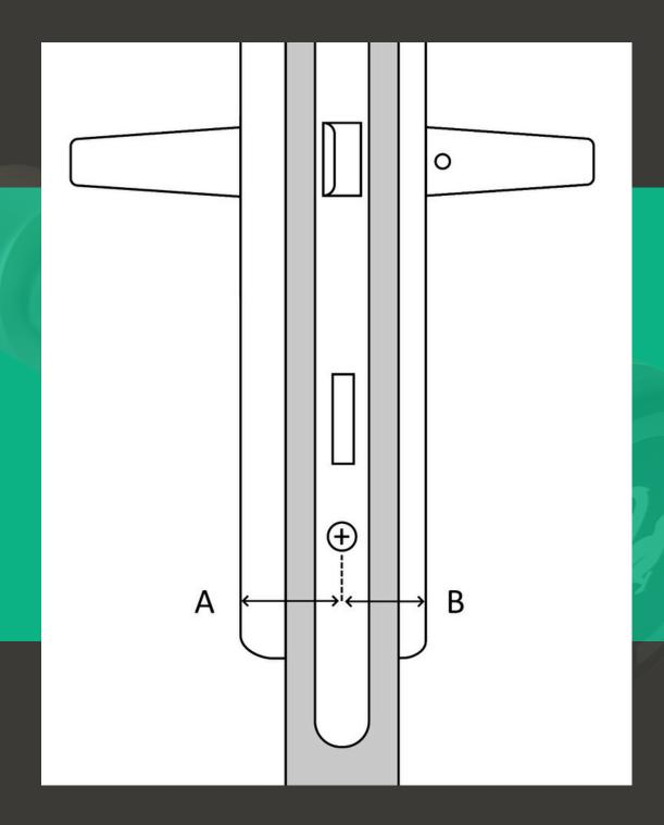
**Tipp:** Das Zylindergehäuse sollte möglichst bündig abschliessen. Messen Sie beispielsweise aussen 38 mm, bestellen Sie einen Zylinder mit 40 mm Aussenlänge.
