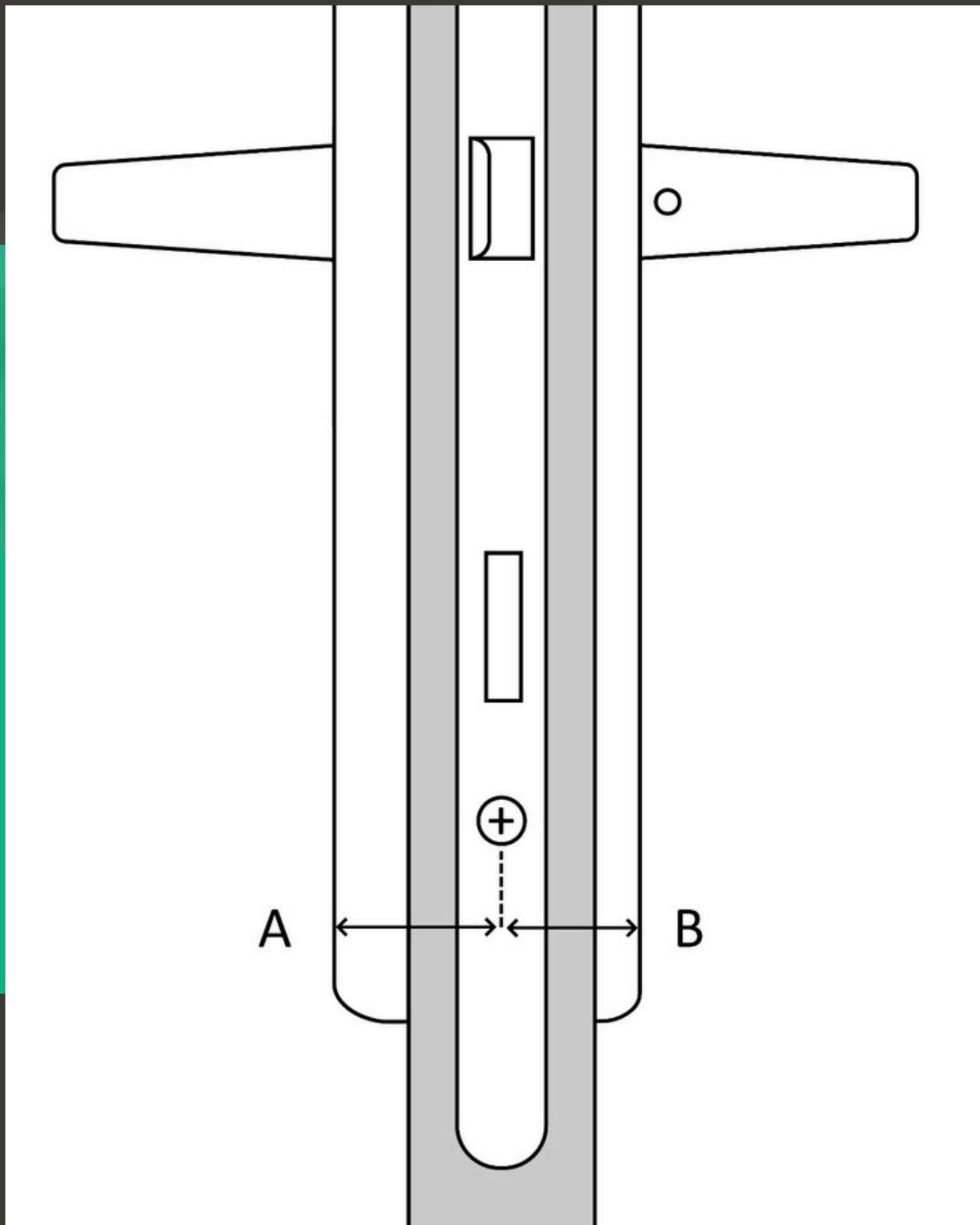
**Tipp:** Das Zylindergehäuse sollte möglichst bündig abschliessen.
